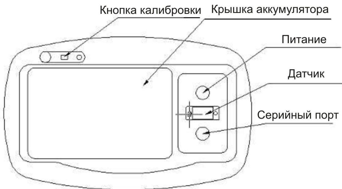
Для входа в режим калибровки используется кнопка на задней панели, закрытая планкой, с возможностью опломбирования после калибровки.
