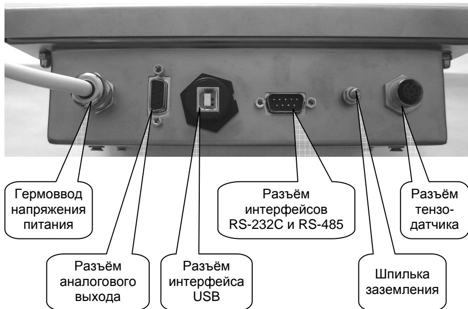
Рис. 4.3. Вид Преобразователя со стороны панели разъёмов и гермовводов.
