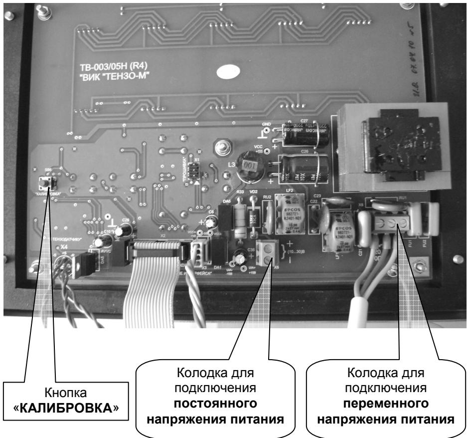
Рис. 4.4. Вид Преобразователя сзади со снятой крышкой.
