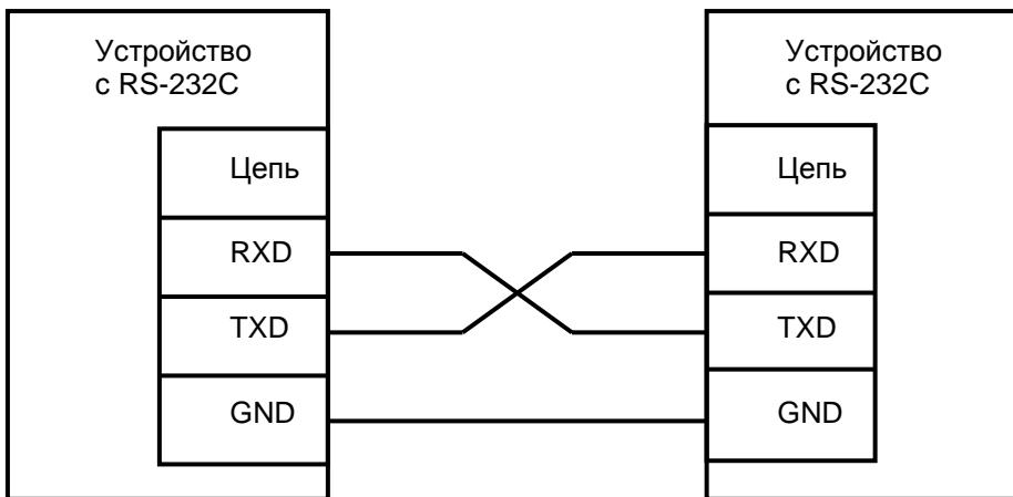
**ВНИМАНИЕ!!!** При использовании покупного кабеля интерфейса RS-232C отключите со стороны Преобразователя от всех контактов разъёма, кроме 2-го, 3-го и 5-го.
