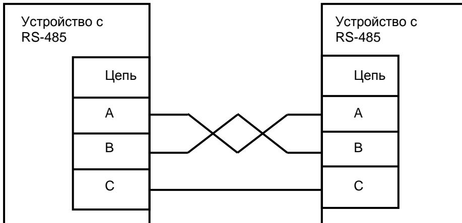
При самостоятельном изготовлении кабеля интерфейса RS-485 последовательно соедините попарно цепи А и цепи В разъёмов RS-485 всех объединяемых устройств кабелем типа «витая пара»; последовательно соедините линии С (общий провод интерфейса RS-485) всех объединяемых устройств.
