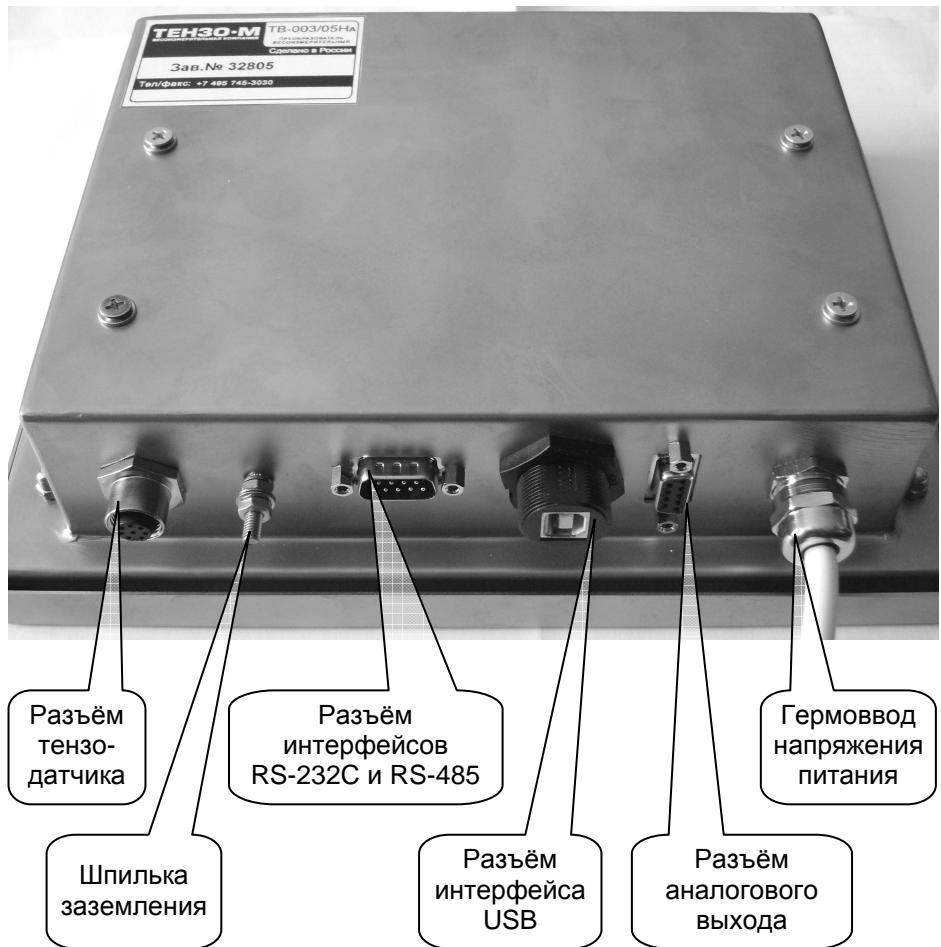
Рис. 4.2. Вид Преобразователя сзади.
