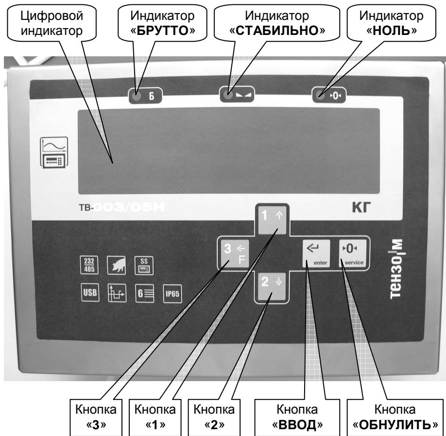
Рис. 4.1. Вид Преобразователя спереди.
