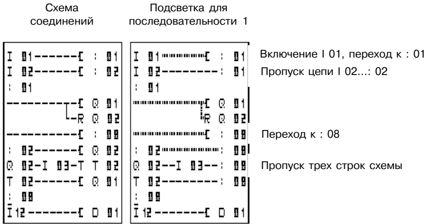
Рис. 6.47. Пример формирования избирательного переключателя с помощью модулей перехода
