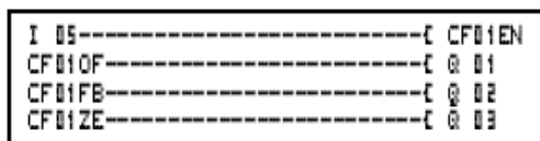
Рис. 6.16. Пример схемы соединений катушек и контактов счетчика частоты CF01
