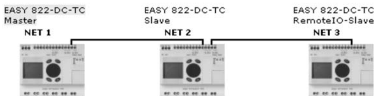
Рис. 8.33. Сетевое соединение программируемых реле
