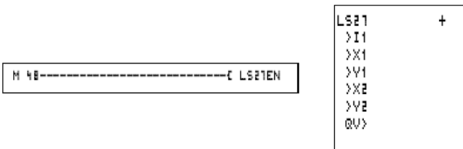
Рис. 6.64. Пример схемы соединения и дисплея настройки параметров модуля масштабирования LS27
