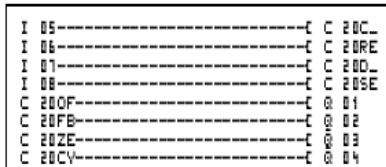
Рис. 6.14. Пример схемы соединений катушек и контактов счетчика C 20
