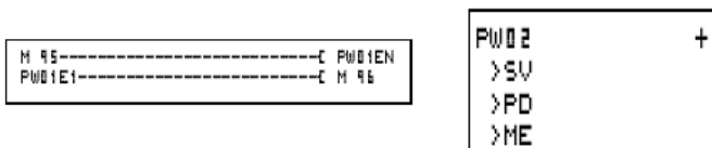
Рис. 6.61. Схема соединений и дисплей параметров модуля ШИМ PW02
